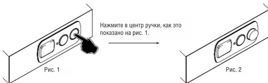
После разблокировки ручки (показана на рис. 2) вы сможете отрегулировать температуру. По окончании работы повторно нажмите на центральную часть ручки и заблокируйте ее.
