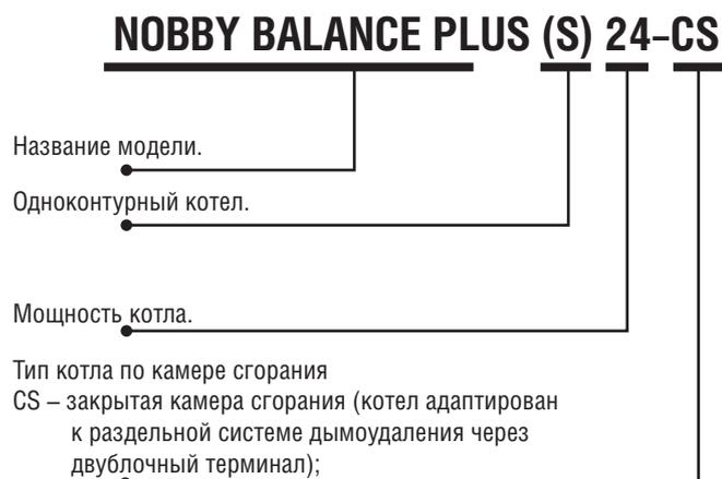
Газовые одноконтурные настенные котлы с закрытой камерой сгорания NOBBY BALANCE PLUS (S) снабжены системой самодиагностики и различными системами безопасности, такими, как:
