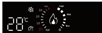
При закрытии крана горячей воды котел самостоятельно перейдет из режима ГВС в режим отопления.
