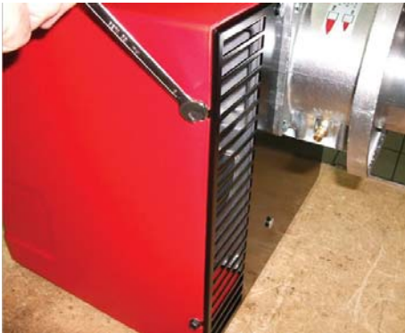
1) Снять кожух, ослабив 4 винта;
