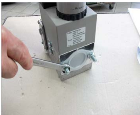
7) Снять заглушку из электроклапан;
