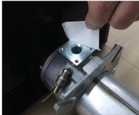
2) повернуть Горелка и Снять заглушку;
