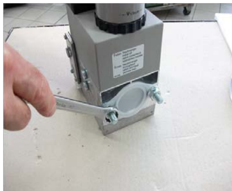
8) Снять заглушку из электроклапан;
