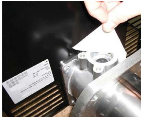
2) повернуть Горелка и Снять заглушку;
