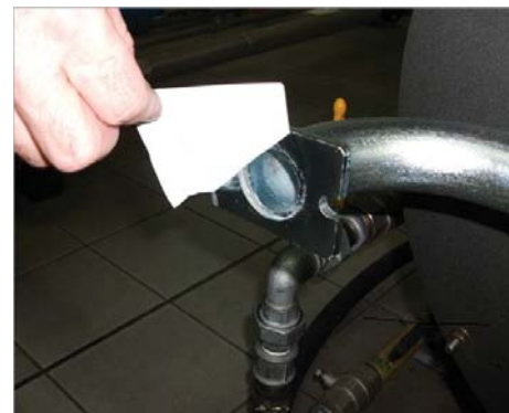
6) Снять заглушку из Труба ГАЗОВОЙ рампы;
