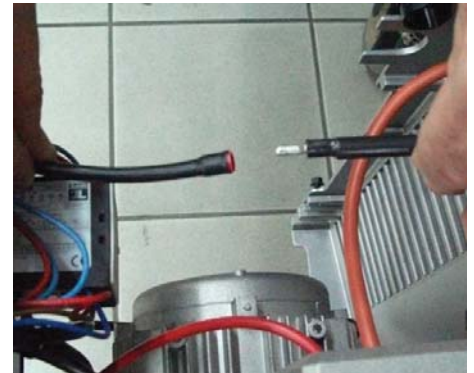
15) Подсоединить кабель электрода ионизации к разъему;
