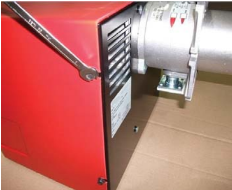
1) Снять кожух, ослабив 4 винта;
