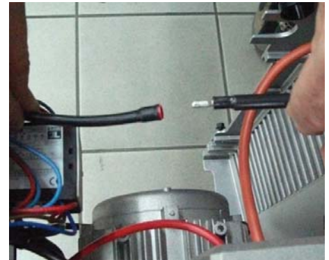
3) Отсоединить кабель электрода ионизации от разъема;
