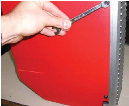
1) Снять кожух, ослабив 4 винта;
