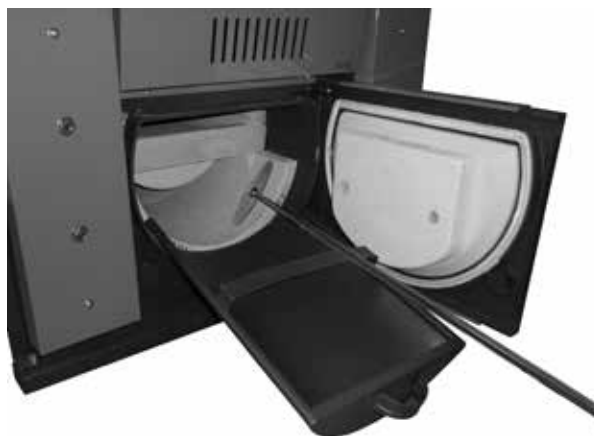
Открытое пространство нижней части котла со сферической камерой и пример золы с зольник и пепельницы
