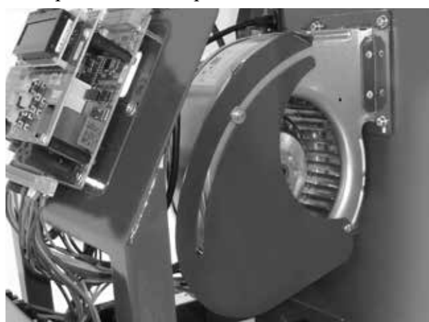
Вентилятор горелки с воздушной заслонкой. Открытием воздушной заслонки сокращается длина пламени.
