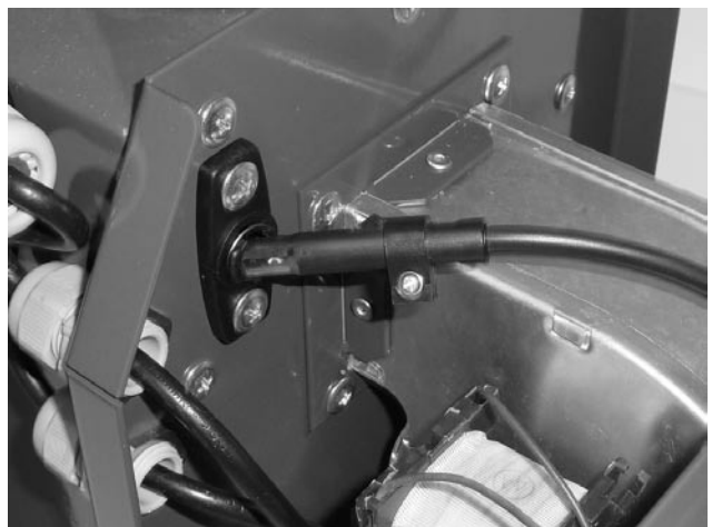
Рис. 6 – фотозлемент – обратите внимание на правильную ориентировку – рекомендуем осуществлять очистку не реже одного раза в год
