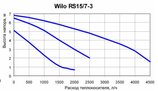
Рис.19. Высота напора насоса «Wilo RS15/7-3»
